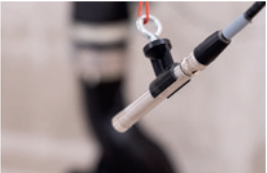
Măsurarea acustică în cameră a sunetului degajat în aer de la o instalație Geberit Silent-db20 Sovent.
