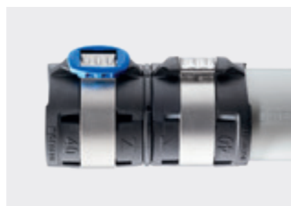
↑ Ușor de recunoscut chiar și în colțurile întunecate: dacă indicatorul de presare se află încă pe fittingul Geberit FlowFit, îmbinarea nu a fost încă presată.
