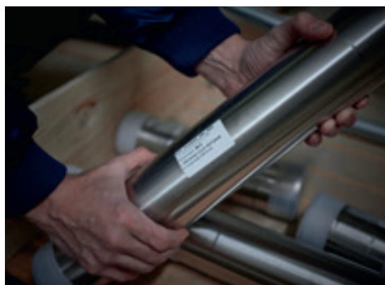
Instalare ușoară datorită etichetării detaliate și clare a secțiunilor de țevă tăiate la o anumită lungime.
